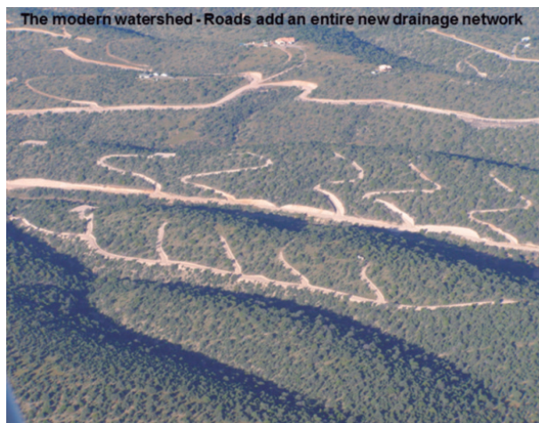
FIGURA 3. Red de caminos que se añade a la red natural de drenaje. Silver City, NM.
